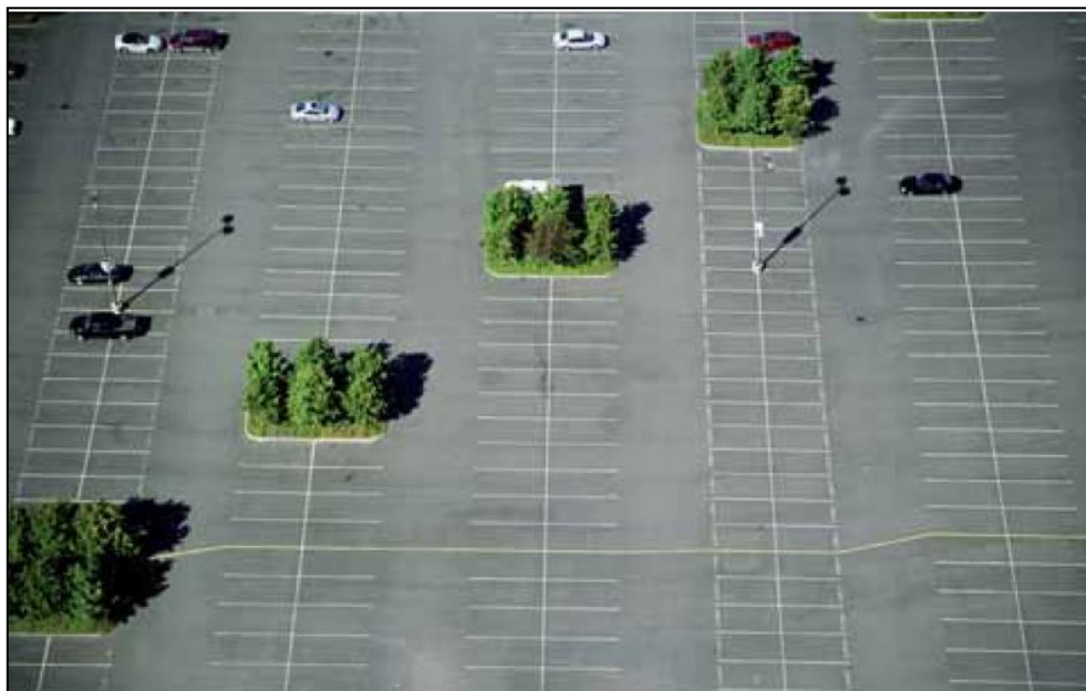
Figura 7:3 – Esempio di bacini naturali per captare le acque dalle superfici impermeabili (fonte: "Orientamenti in materia di buone pratiche per limitare, mitigare e compensare l'impermeabilizzazione del suolo")
