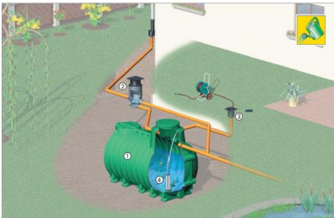
Figura 2:5 – Sistema di recupero delle acque meteoriche
